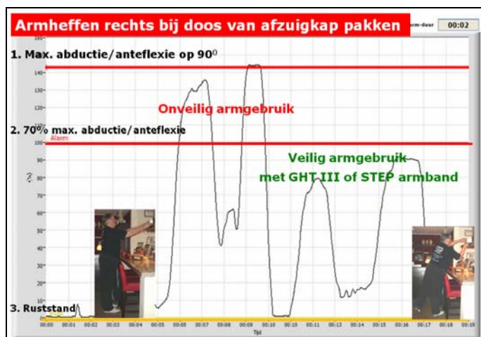
Afb. 7. De BodyGuard grafiek van de bovenarmbeweging bij een ADL handeling met onveilig en veilig schoudergebruik.
