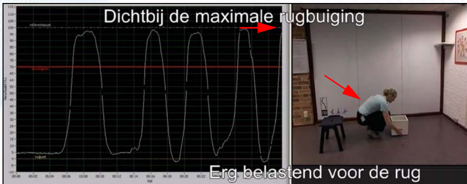
Afb. 2. Nadat de maximale buiging is vastgelegd (witte lijn) worden 5 standaard handelingen verricht. De meting met de BodyGuard laat dan zien hoe de rug beweegt t.o.v. de alarmgrens en de maximale buiging. De alarmgrens (rode lijn) wordt op 70% van de max. buiging ingesteld. In de afb. is te zien dat de rug zich dicht bij de maximale buiging bevindt (rode pijlen).
